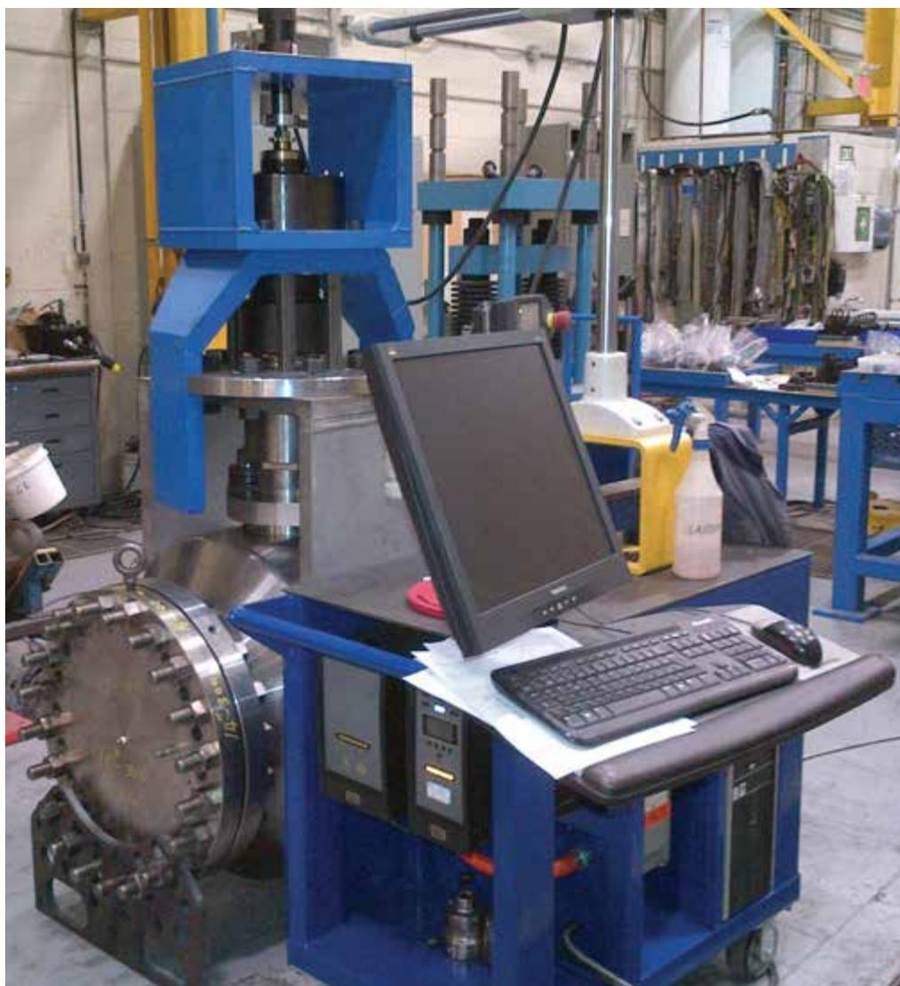
Le robinet-vanne à tournant sphérique à sièges métalliques Securaseal de type R de 16 po, de classe 300, que l'on voit ci-dessus est manœuvré à l'aide de l'instrument de mesure à montage direct de 50 000 Nm +/- 7,5 %, en utilisant le contrôleur mobile de Velan et un support permettant un déplacement vertical autoréglable, ce qui en fait un instrument polyvalent pouvant être utilisé sur une vaste gamme d'appareils de robinetterie.
