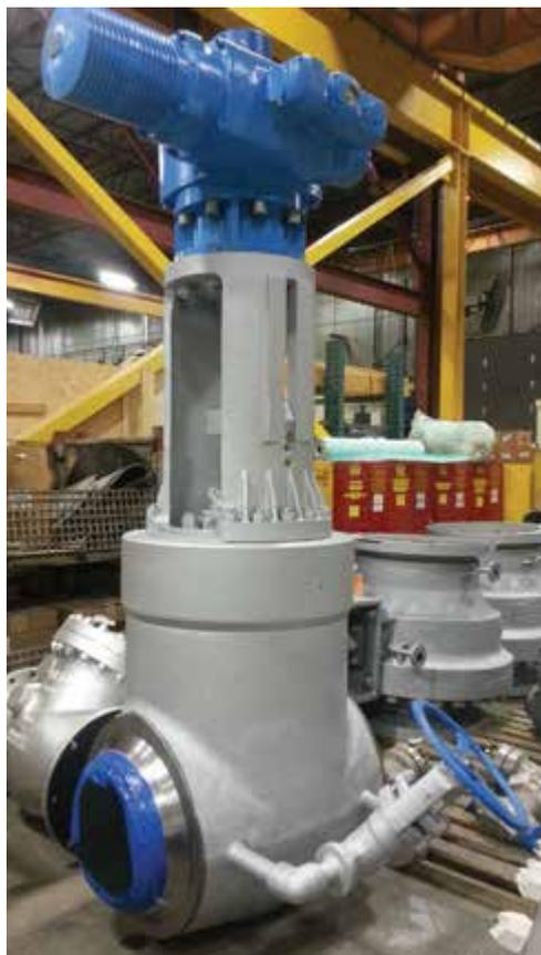
Préparation d'un robinet-vanne autoclave de 20 po, de classe de pression spéciale 2900, équipé d'un actionneur électrique, en vue de son expédition en Inde.
