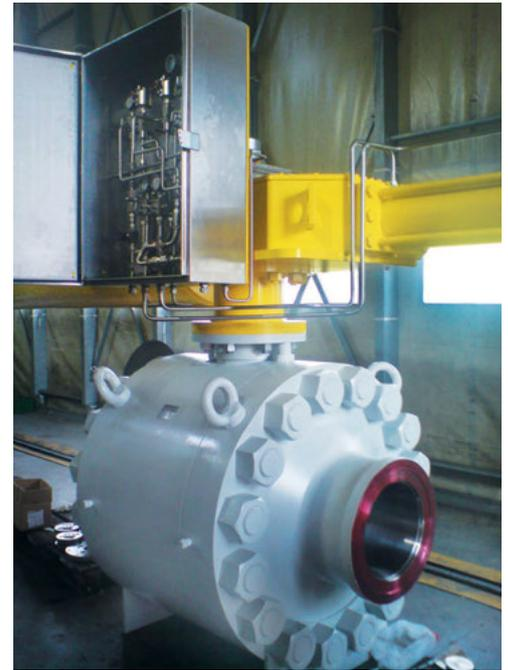
*Une robinet complet de système d'arrêt d'urgence à passage intégral de 450 mm (18 po) de classe 2500 avec un actionneur hydraulique SY et un dispositif manuel PST pour le service en mer en situation grave.*
