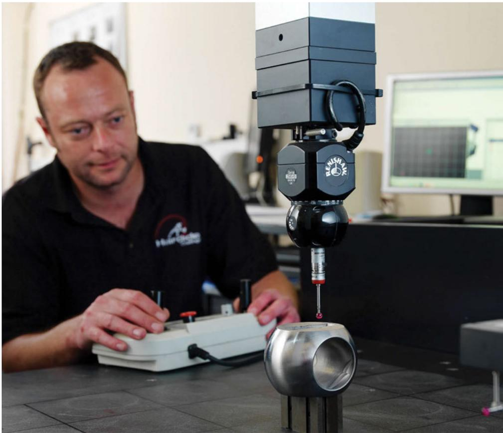
Une sphère de Velan sur la MMT (machine à mesurer tridimensionnelle) de Hardide.
